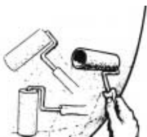
Fig: Bruk en tynn skumrulle (art.nr. 800B) og legg jevne strøk med epoksy.
